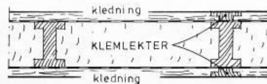
C. Klemming. Horisontalsnitt vegg, eksempel med klemming av kledning
