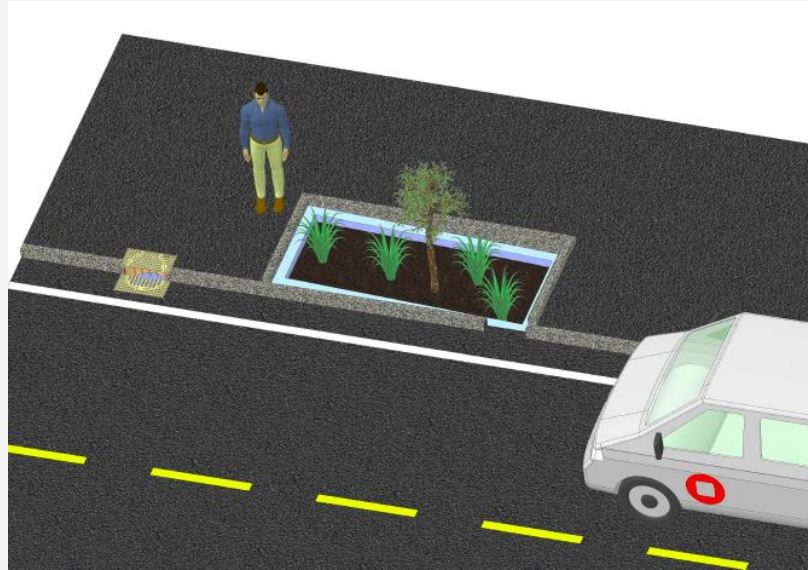
Innløp via regnbed, overløp via kjeftsluk
