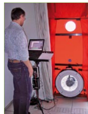
Figur 5: Tetthet måling i bygg med "Blower door" utstyr /9/
